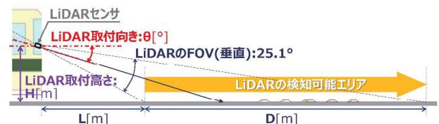
図3 LiDAR センサの検知可能エリア
