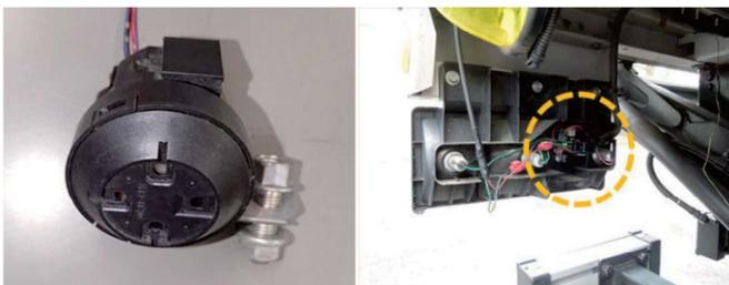
図1 後退時警報装置とその取付け例
