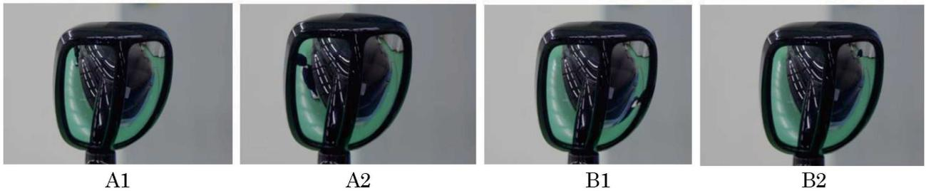
図5 直前直左鏡による見え方（ダミー人形）
