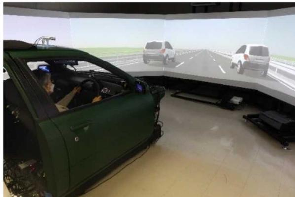
図1 定置型ドライビングシミュレータ
