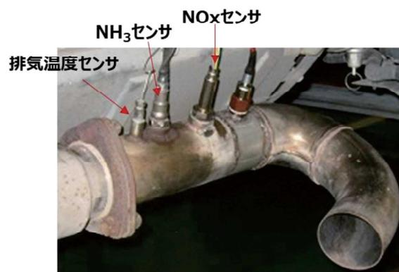
図 1 SEMS のテールパイプへの取付状況
