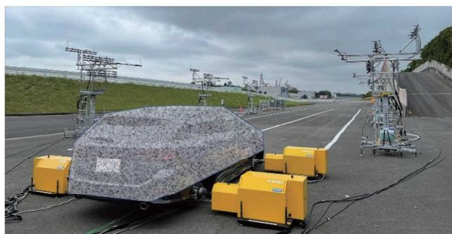
図1 導入した降雨装置
