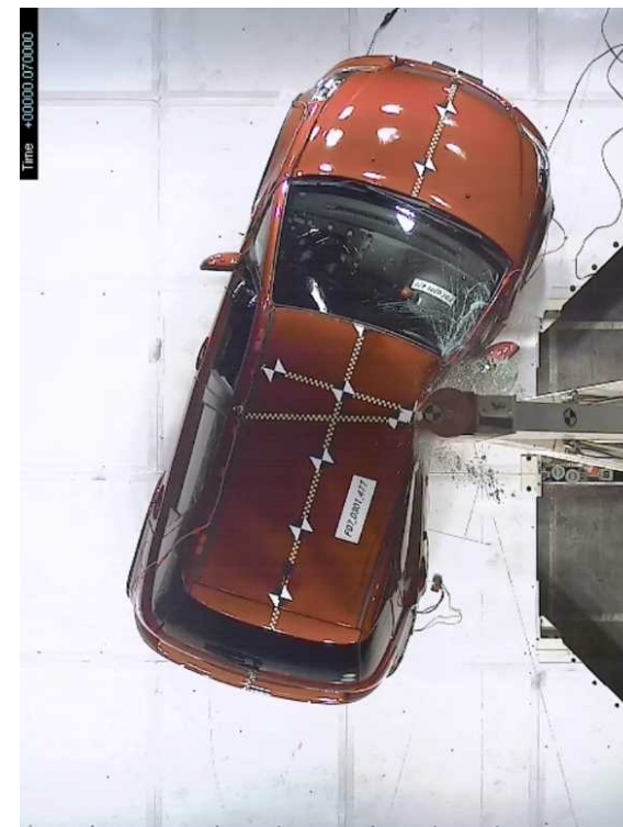
ポール側面衝突時の乗員保護試験 (衝突試験棟を平成32年度までに整備予定)
