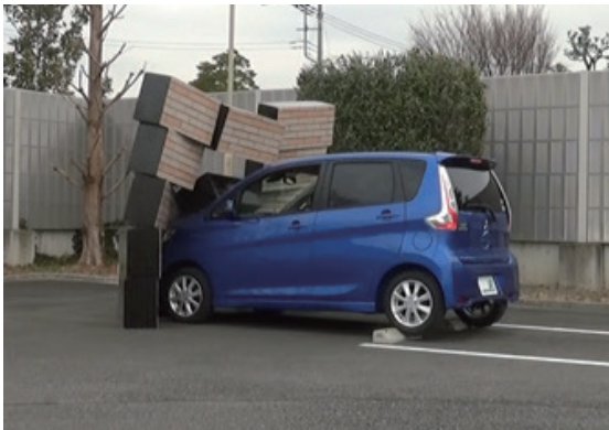
図2 ペダル踏み間違い時加速抑制装置作動確認実験
