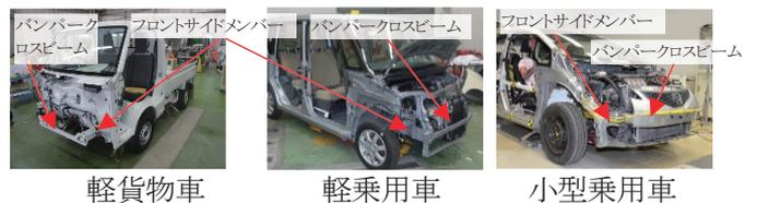
図2 試験車両の前面構造
