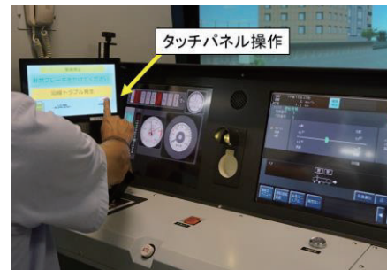
図4 運転支援装置と外部演算装置の相互通信実験
