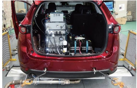
図3 車載式排出ガス測定システム（PEMS）
