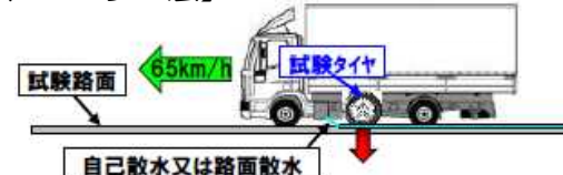
図3：転がり抵抗の試験法
