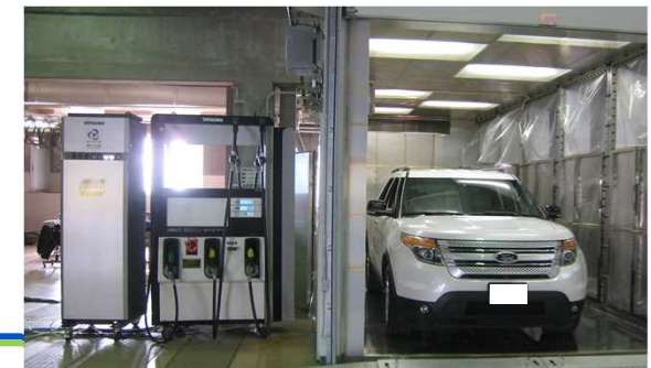
SHED設備におけるエバポ測定
