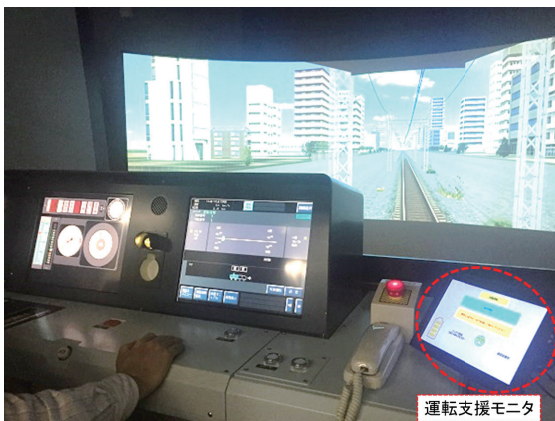
図7 運転支援装置の検証状況
