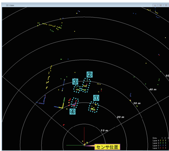
図6 停止している物体の検知状況
