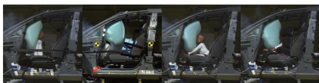
(a) 膝伸ばし (b) 膝曲げ (c) シートベルト有り (d) CRS使用 トップマウントタイプエアバッグ
