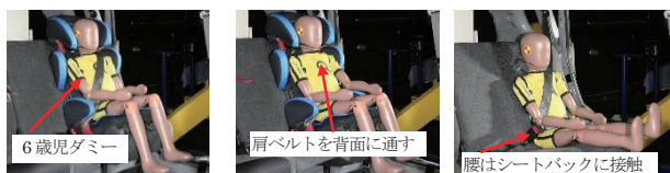
B1 適正使用 B2 肩ベルト経路違い B3 チャイルドシート不使用
