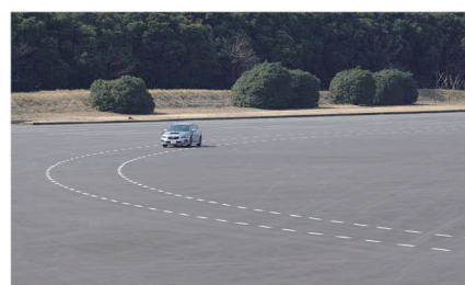
図4 車線維持機能確認試験の様子
