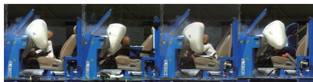
(a) 膝伸ばし (b) 膝曲げ (c) シートベルト有り (d) CRS使用 フロントマウントタイプエアバッグ
