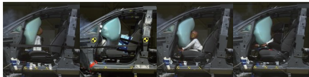
(a) 膝伸ばし (b) 膝曲げ (c) シートベルト有り (d) CRS使用 トップマウントタイプエアバッグ
