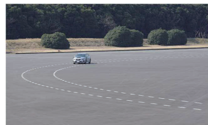
図4 車線維持機能確認試験の様子
