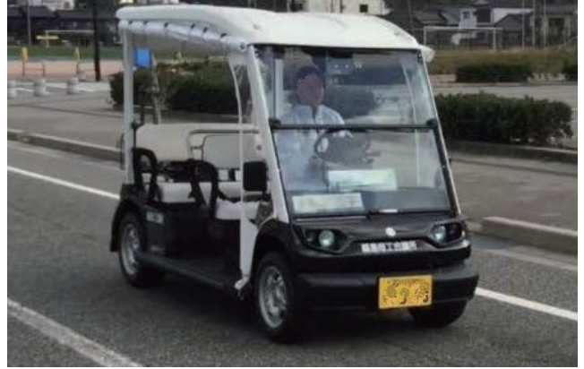
図1 ゴルフカートをベースとした電動車両
