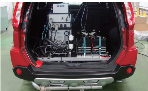
図2 車載式排出ガス測定システム(PEMS)
