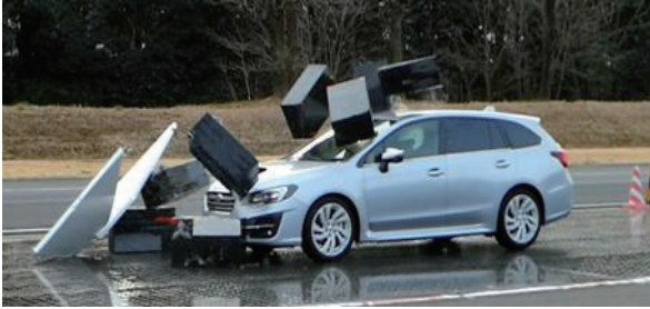
図1 対車両衝突被害軽減ブレーキの作動確認実験
