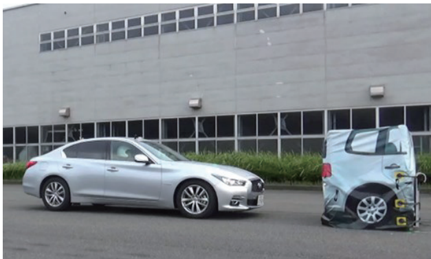
図 2 衝突被害軽減ブレーキに係る認定試験
