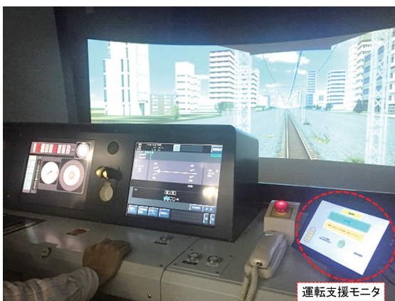
図7 運転支援装置の検証状況
