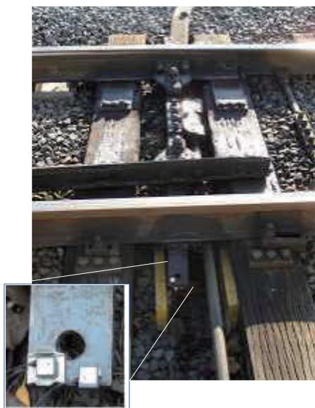
図4 センサの取付け状況
