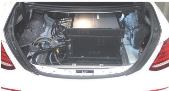
図1 車載式排出ガス測定システム（PEMS）
