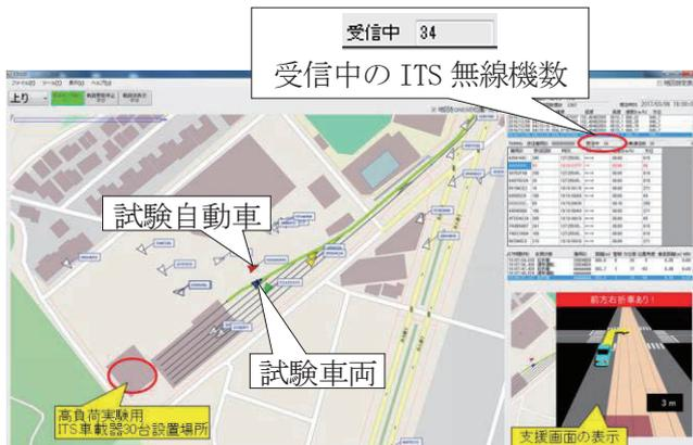
図12 高負荷実験時の処理装置画面
