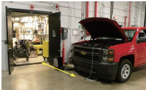
図 9 EPA-NVFEL におけるエンジン試験方法<sup>5)</sup>
