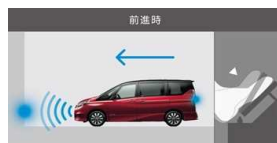
ペダル踏み間違い時加速抑制装置
