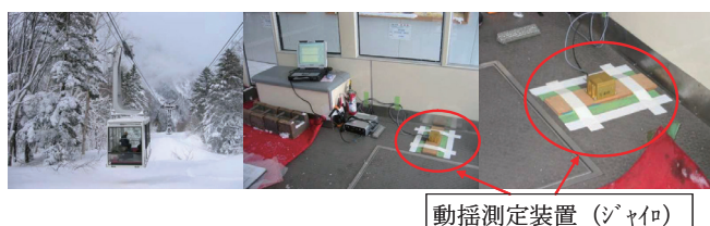
図2 実搬器試験状況
