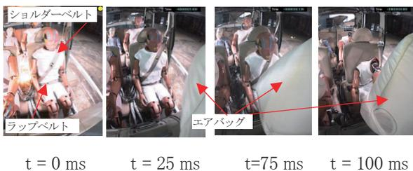
図5 ダミーの挙動 (衝突速度 40km/h)
