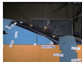
図 12 歩行者エアバッグ無し条件での頭部インパクト最大加速度時の状況
