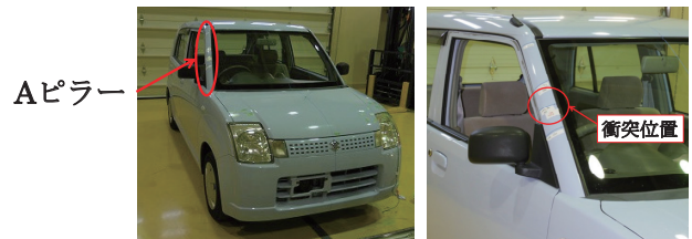
図 5 実験車両・実験衝突位置
