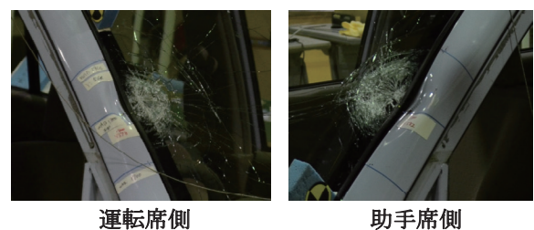
図 6 実験後の A ピラー変形状況
