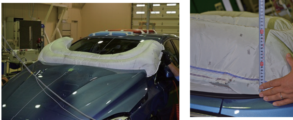
図 14 歩行者エアバッグの空気充填状況
