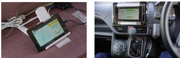
図8 列車及び自動車に搭載したクライアント端末
