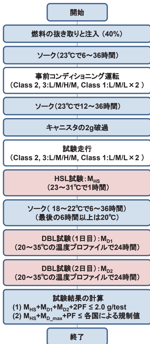
図 2 エバポ試験法案（非密閉タンクシステム）
