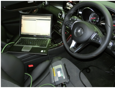
図5 スキャンツールによる自己作動診断の検証
