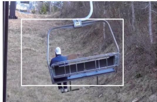
図12 片側乗車により傾いた搬器
