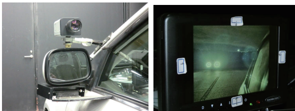
図5 CMS カメラ設置位置 図6 CMS モニタ画像
