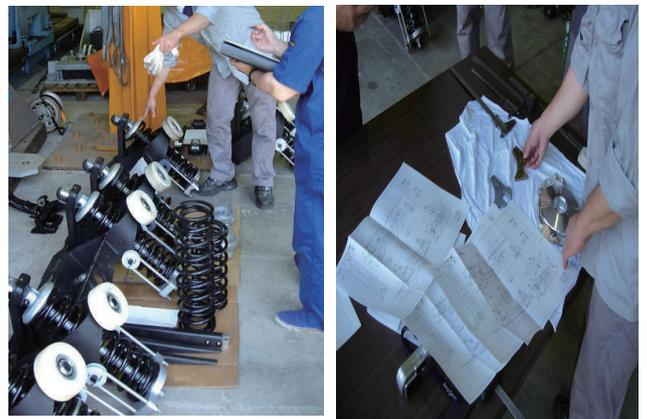
図2 形状及び寸法検査の状況
