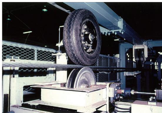
図6 脱索防止装置の機能試験（タイプB）
