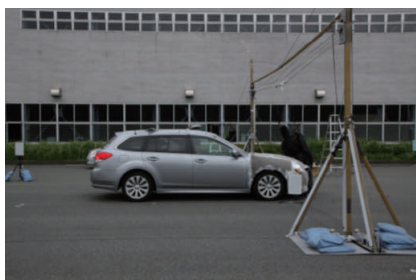
図6 歩行者ダミーの道路横断模擬装置
