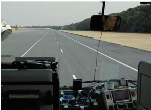
図3 車線逸脱警報装置の試験
