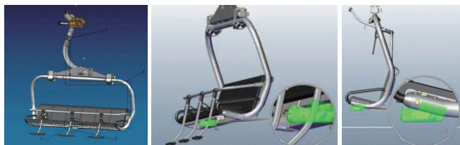
図7 セーフティバーの汎用型ロック機構(Magnestick bar)
