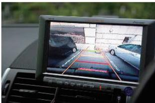
図1 従来のモニタシステム
