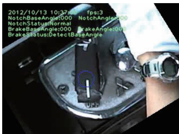
図2 力行ノッチの画像解析例
