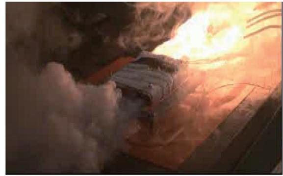
図4 加熱試験の状況の一例(LNCM)
