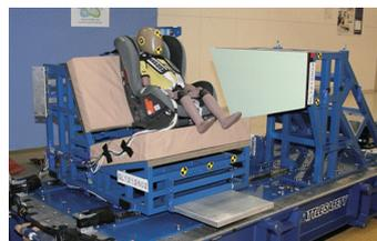
図2 CRS側面衝突試験装置
