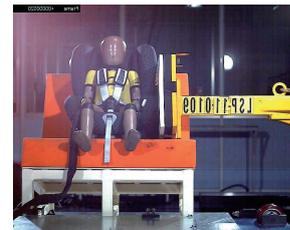
図8 減速式スレッド試験機による実験の様子
