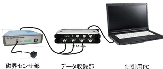
図1 磁界測定機概略図
