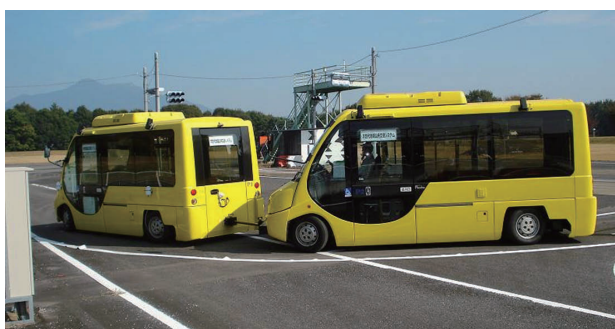
図 4 BMT の急曲線における連結走行実験
