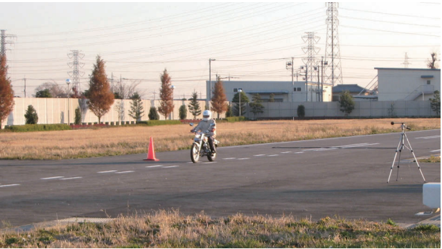
図 2 加速走行騒音試験の様子
