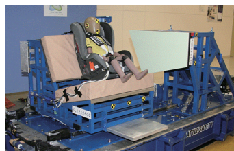
図 2 CRS 側面衝突試験装置
