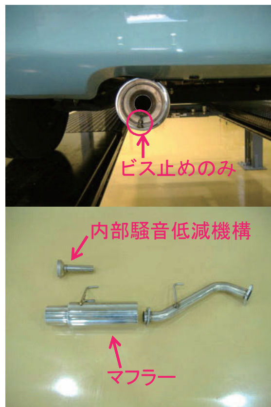
図1 騒音低減機構が容易に取り外し可能なマフラーの例
