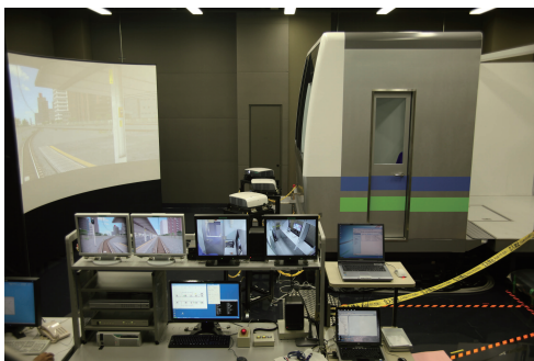
図6 列車運行安全性評価シミュレータ 外観
