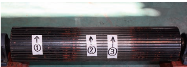
図4 大小兼用型のブレーキ・テスト用ローラ
