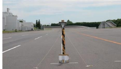
図2 コーナーリフレクタを用いた静止障害物
