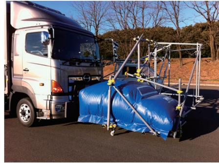
図1 風船型を用いた移動障害物
