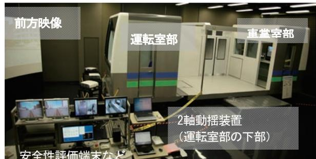
図2 シミュレータの機器構成
