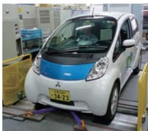
Fig.2 試験車両の CDY 試験の様子
