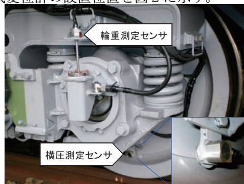
図2 脱線係数常時観測用台車及びセンサ
