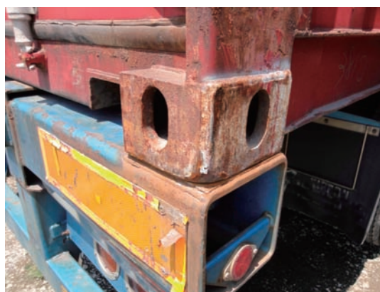
図2 コンテナすみ金具
