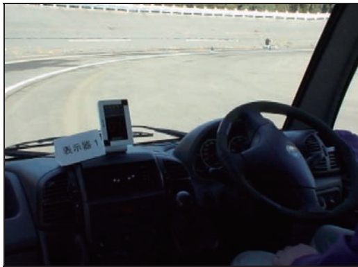
図 11 光学式車両誘導システムによる自動操舵状況
