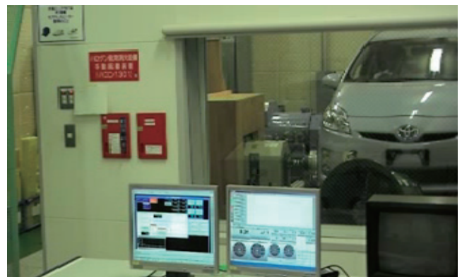
図5 実車走行模擬装置による測定状況
