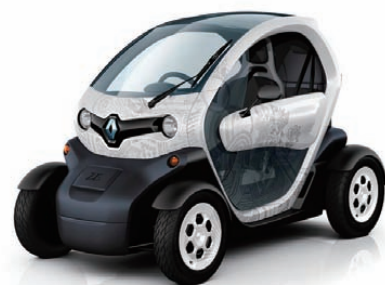
図12 欧州で市販予定の2人乗り超小型モビリティ(ルノー(仏)製: Twizy、車両重量450 kg)
