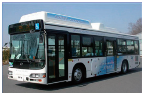
図1 非接触給電システム搭載のプラグインハイブリッド自動車
