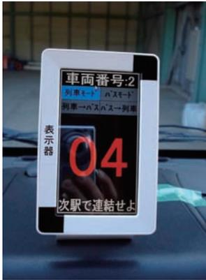
図8 試作した運転士指示表示器
