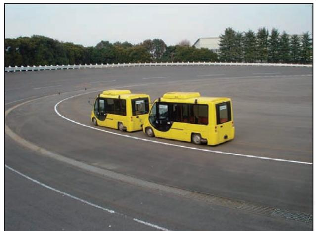
図10 連結・曲線走行実験中の試験車両
