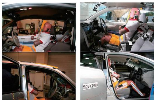
図2 ダミーの搭載状況比較
