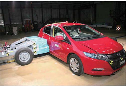
・現行法規のMDB (Mobile Deformable Barrier) を用い、後輪付近に搭載したリチウムイオン蓄電池への衝突を想定した側面衝突試験を実施
