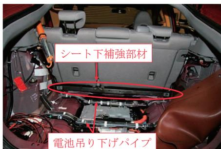
図5 後席シート，電池構造
