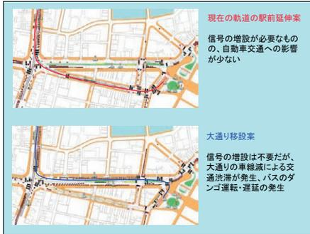
シミュレーションによるLRT導入効果評価例
