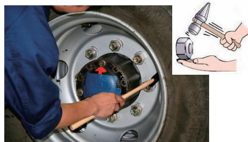
図8 点検ハンマによる点検
