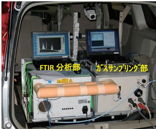
図2 車載式FTIR分析装置の外観
