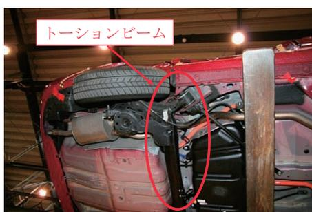
図4 後輪サスペンション部構造
