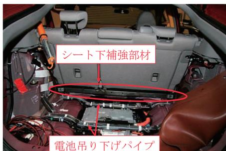
図5 後席シート，電池構造
