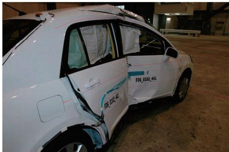
図7 ポール側面衝突試験後車両
