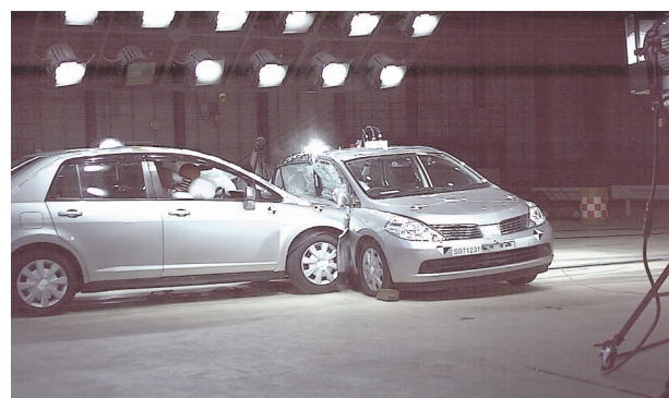
図1 車対車の側面衝突実験の状況
