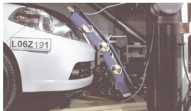
図2 歩行者脚部インパクト衝撃試験の状況
