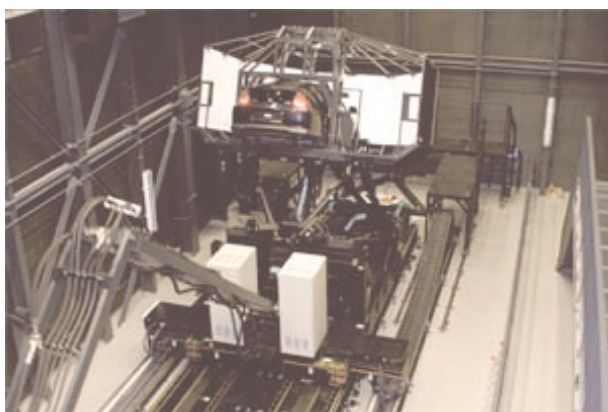
図4 並進機構付ドライビングシミュレータ
