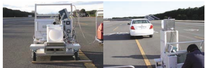
図13 レーダー反射強度の計測風景
